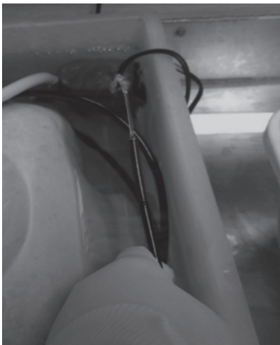
รูปที่ 7. การตรวจสอบว่าน้ำยาฆ่าเชื้อสามารถฉีดล้างในช่องสำหรับใส่อุปกรณ์ของกล้องได้อย่างถูกต้อง
