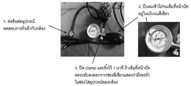
รูปที่ 5. การทดสอบการรั่วของกล่องโดยใช้อุปกรณ์ทดสอบการรั่ว
